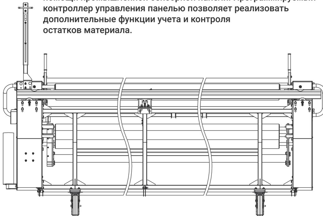
Питание устройства осуществляется через подвижный токосъемник закрытого шинпровода троллейного типа, что позволяет устройству перемещаться вдоль ряда обслуживаемого оборудования, обеспечивает устройству мобильность и безопасность в эксплуатации.
