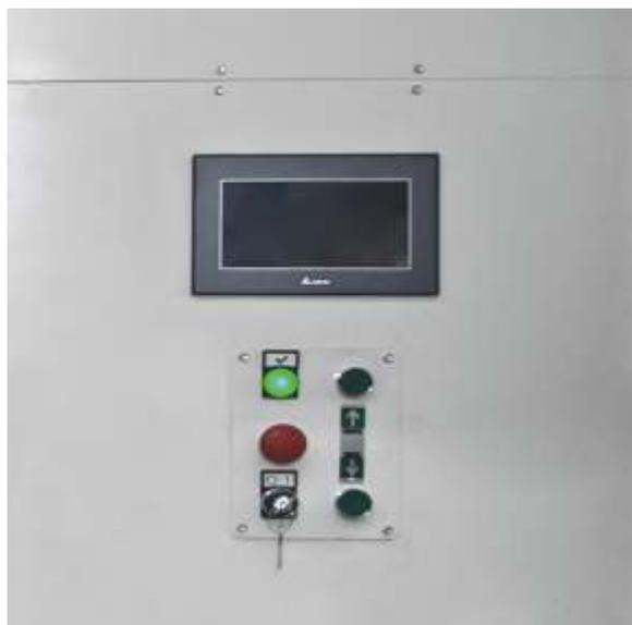
Система автоматизированного управления патерностером разработана для подачи выбранного рулона потребителю, а также позволяет присвоить нужный артикул каждому виду напольного покрытия.
